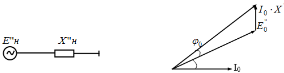
Рис. 5.2. Схема заміщення та векторна діаграма навантаження електродвигуна в початковий момент КЗ
