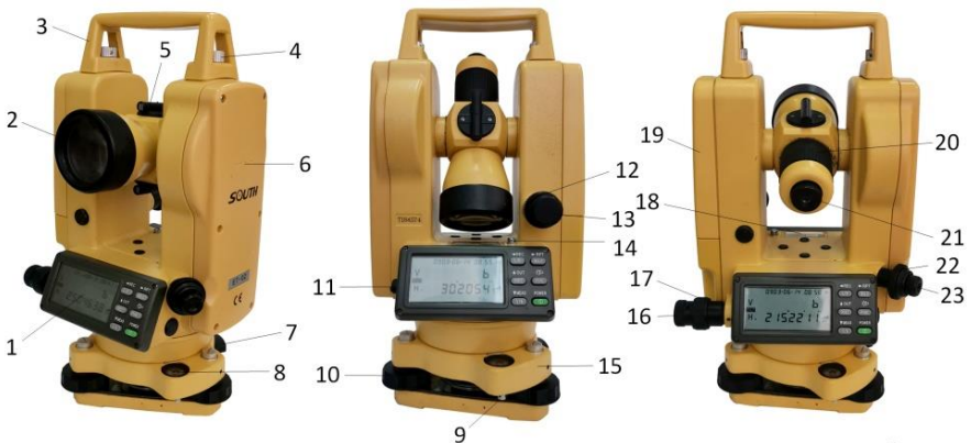
Рис. 6.1. Загальна будова електронного теодоліта South ET-02 1 – дисплей; 2 – об’єктив; 3 – ручка; 4 – фіксуєчий гвинт ручки; 5 – візор; 6 – мітка висоти інструмента; 7 – засувка трегера; 8 – круглий рівень; 9 – юстувальний гвинт круглого рівня; 10 – піднімальні гвинти; 11 – роз’єм для під’єднання до ПК; 12 – закріпний гвинт ВК; 13 – навідний гвинт ВК; 14 – юстувальний гвинт циліндричного рівня; 15 – трегер; 16 – навідний гвинт ГК; 17 – закріпний гвинт ГК; 18 – циліндричний рівень; 19 – акумуляторний відсік; 20 – кремальєра; 21 – окуляр зорової труби; 22 – фокусувальний гвинт оптичного центра; 23 – окуляр оптичного центра.
