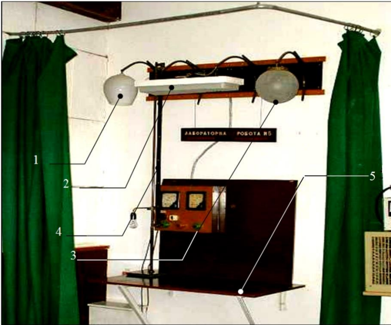
Рис. 4.2. Загальний вигляд лабораторної установки: 1 – люцетга; 2 – люмінесцентна лампа; 3 – куля молочного скла; 4 – штанга; 5 – робоча поверхня
