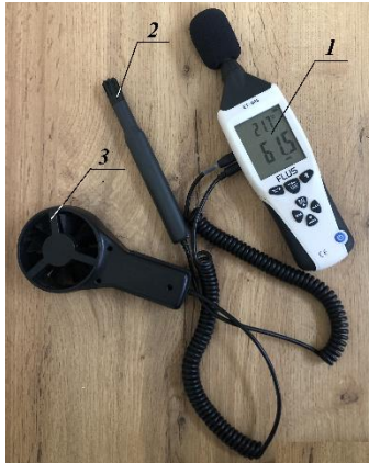
Рис. 2.5. Багатофункціональний вимірювальний прилад ET-965 FLUS: 1 – прилад з дисплеєм і вмонтованим приймачем шуму; 2 – датчик вологості і температури повітря; 3 – датчик руху повітря (крильчатка анемометра).
