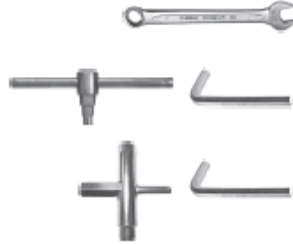
Рис. 17. Інструмент для монтажу: гайковий ключ 27 і 30 мм; монтажний або шестигранний ключ 13 мм; універсальний ключ або шестигранний ключ 8 мм
