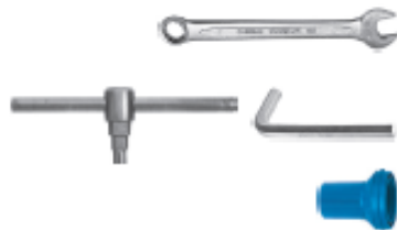
Рис. 5. Інструмент для монтажу: гайковий ключ 27 і 30 мм; монтажний ключ або шестигранний ключ 13 мм; ключ попереднього налаштування
