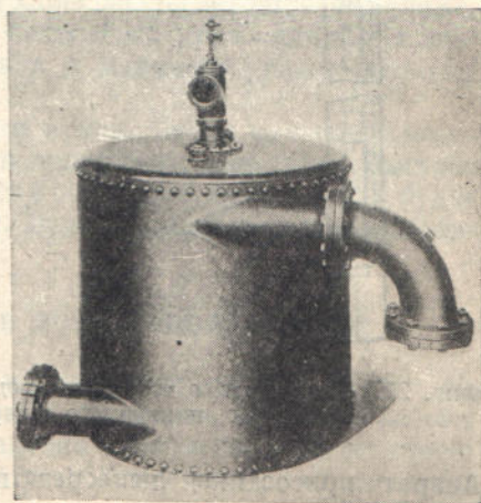
Фиг. 256. Циклонный сепаратор непосредственно у скважины.
