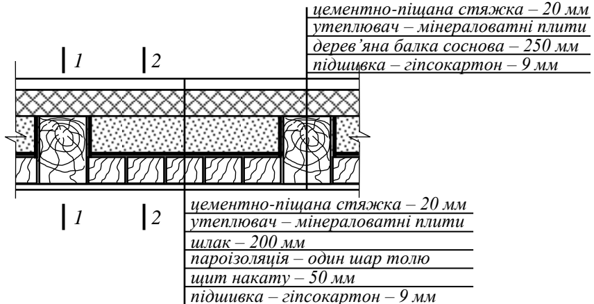
Рис. 5. Конструкція горищного перекриття
