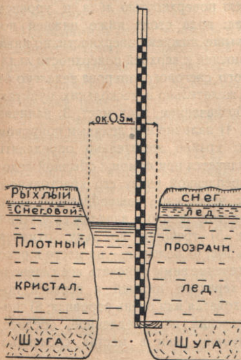
Рис. 8. Простая ледомерная рейка.
