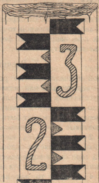
Рис. 3. Образец разметки рейки в Туркестане.
