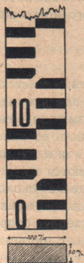
Рис. 2. Образец разметки рейки на Украине.
