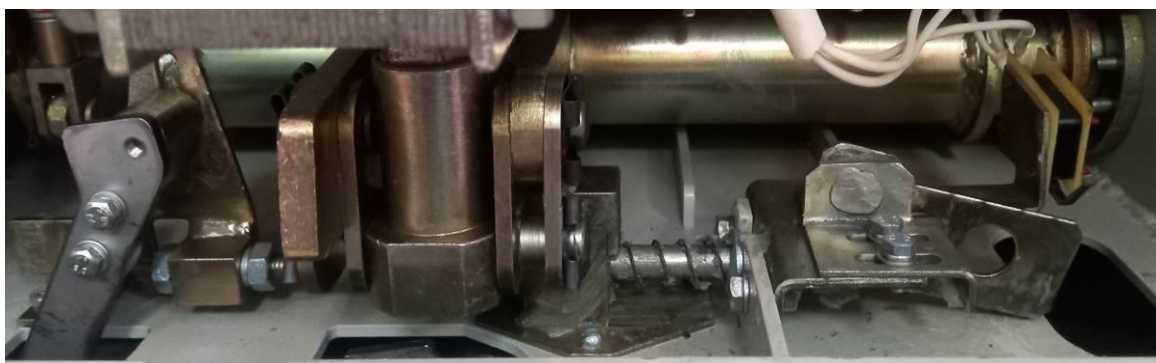
Рисунок 2.23 – Відпущене положення SAB, має місце в проміжному положенні висувного елемента, контакти розімкнені, що забороняє ввімкнення вимикача
