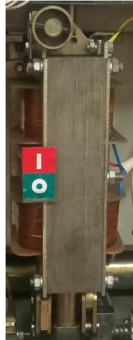
Рисунок 2.4 – Електромагніт вакуумного вимикача ВРС-10: а – креслення; б – фотографія; 1 – лист опорний; 2 – котушка відключення; 3 – постійний магніт; 4 – яркір; 5 – магнітопровід; 6 – котушка ввімкнення; 7 – призма; 8, 9 – шток
