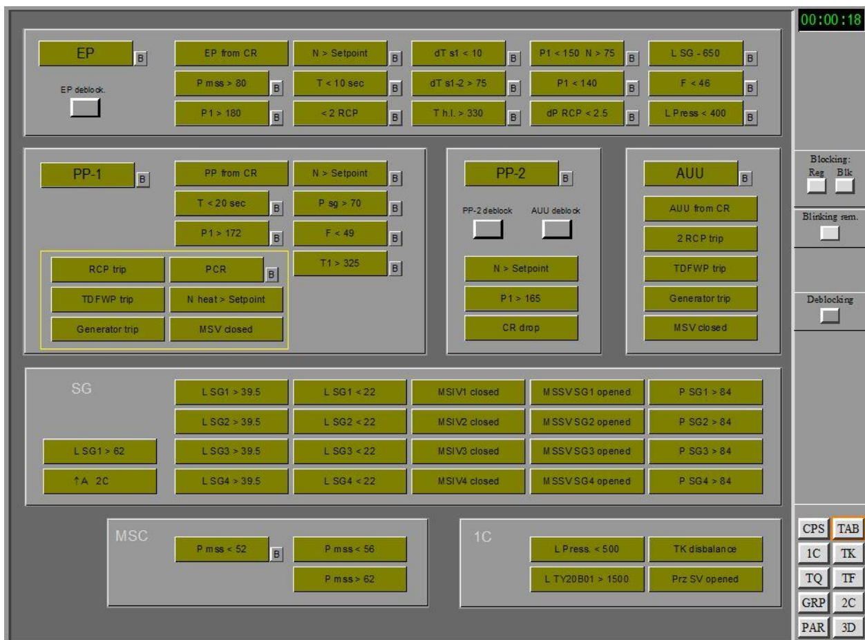
Рисунок 1.24 – Вікно TAB індикаторів попереджувальних та аварійних сигналів
