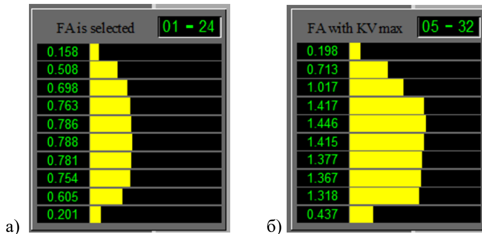
Рисунок 1.34 – Діаграма осьового розподілу відносної потужності ТВЗ: а – виділеної за допомогою лівої кнопки миші; б – що видає максимальну потужність
