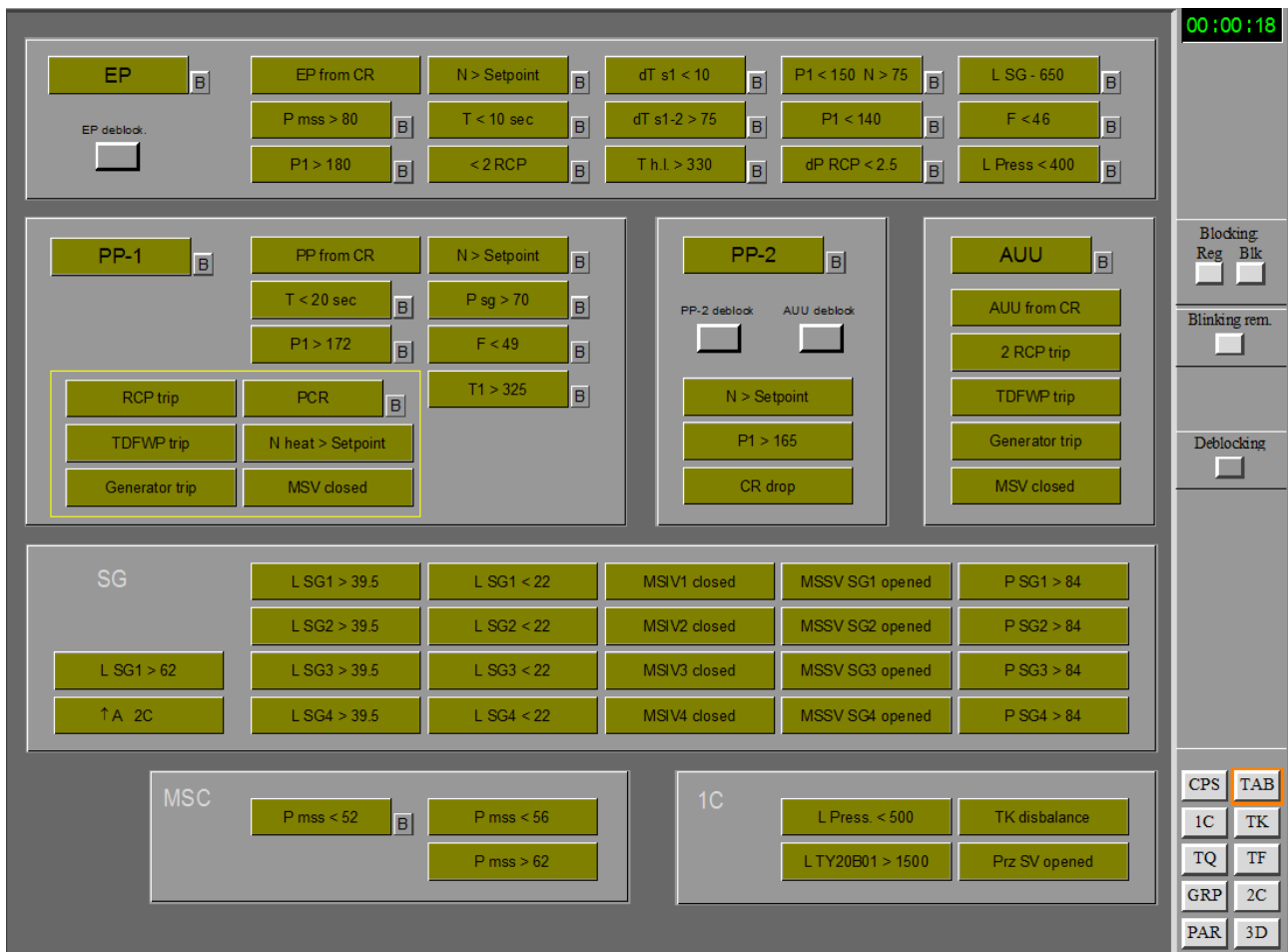
Рисунок 3.3 - Вікно TAB індикаторів попереджувальних та аварійних сигналів
