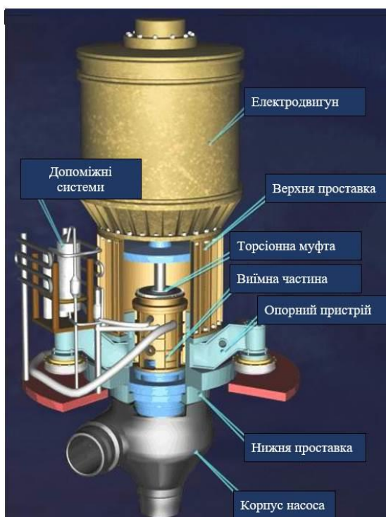
Рисунок 4.4 - Головний циркуляційний насос з електродвигуном
