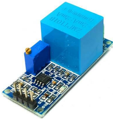
Рисунок 2.7 – Давач напруги типу ZMPT101B: а – загальний вигляд, б – принципова схема
