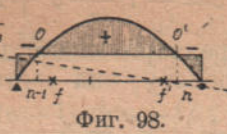
Опасное положение нагрузки для опорного момента M_n Схема эпюры моментов нагруженного пролета
