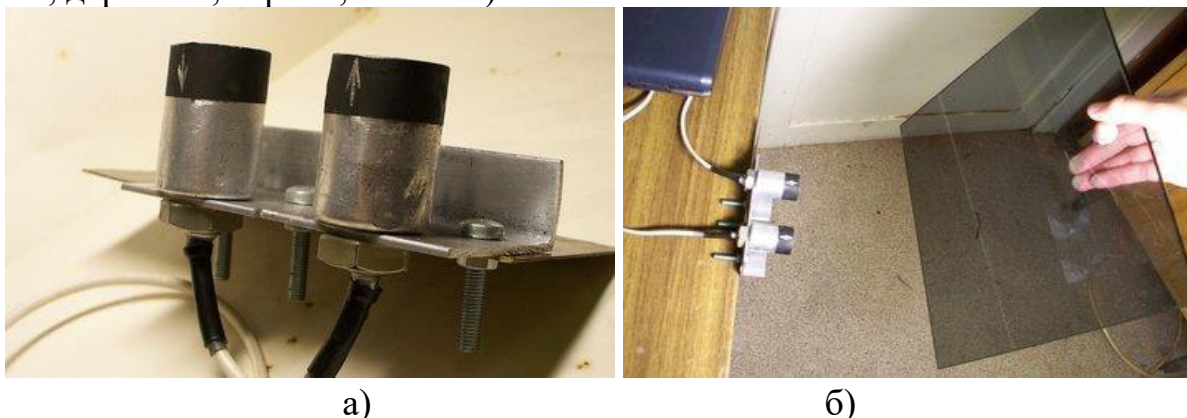
Рис. 2. Зовнішній вигляд ультразвукового прийомопередавача (а) та макетні випробування ультразвукового далекоміра з перешкодою з скла (б)
