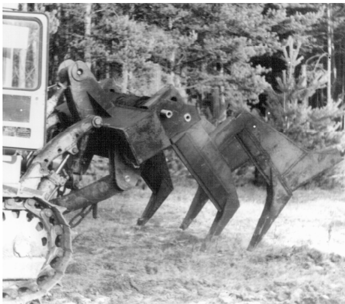
Рис. 3.14. Двоярусні безвідвальні укладачі ЛПО з плоскими та криволінійними різальними частинами ножів: a – з плоскими; б – з криволінійними
