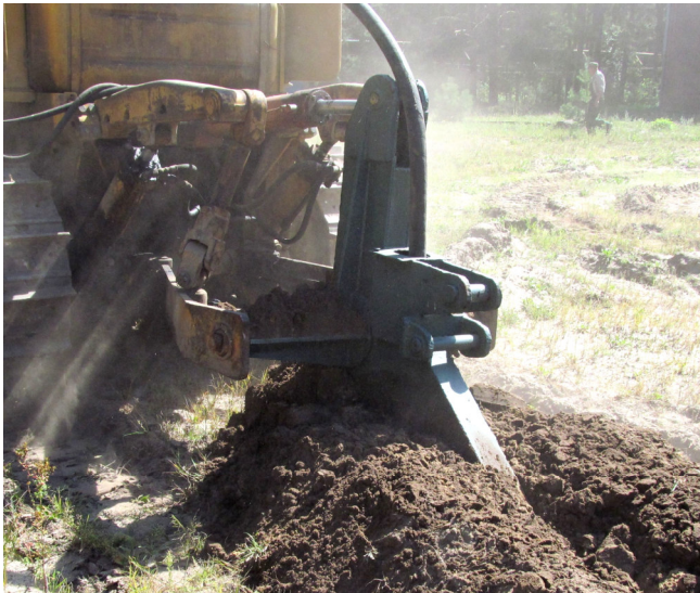
Рис. 3.20. Чотирярусний безвідвальний укладач ЛПО: а – в транспортному положенні; б – в робочому положенні
