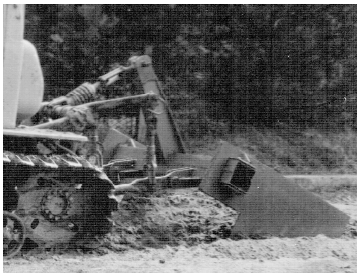
Рис. 3.16. Двоюрисний відвальний об'ємний ґрунторозпушувач: a – в транспортному положенні; б – в робочому положенні
