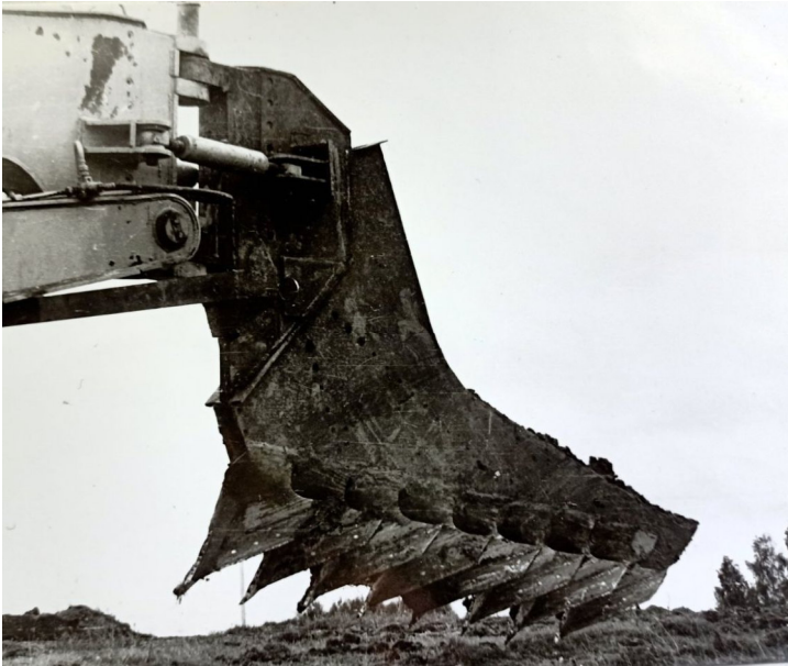
Рис. 3.22. Восьмирусний відвальний укладач ЛПО: a – загальний вигляд на фоні чотирирусного укладача; б – робоча частина
