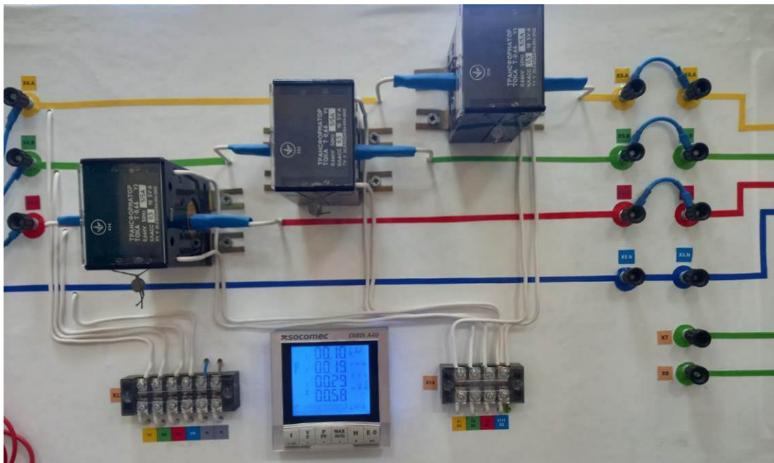
Рис. 2.24. Лабораторний стенд для дослідження функціонування цифрового аналізатора параметрів мережі DIRIS A40
