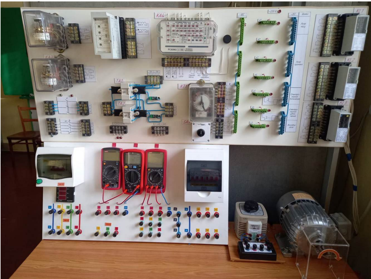
Рис. 1.3. Лабораторний стенд для дослідження функціонування релейного захисту
