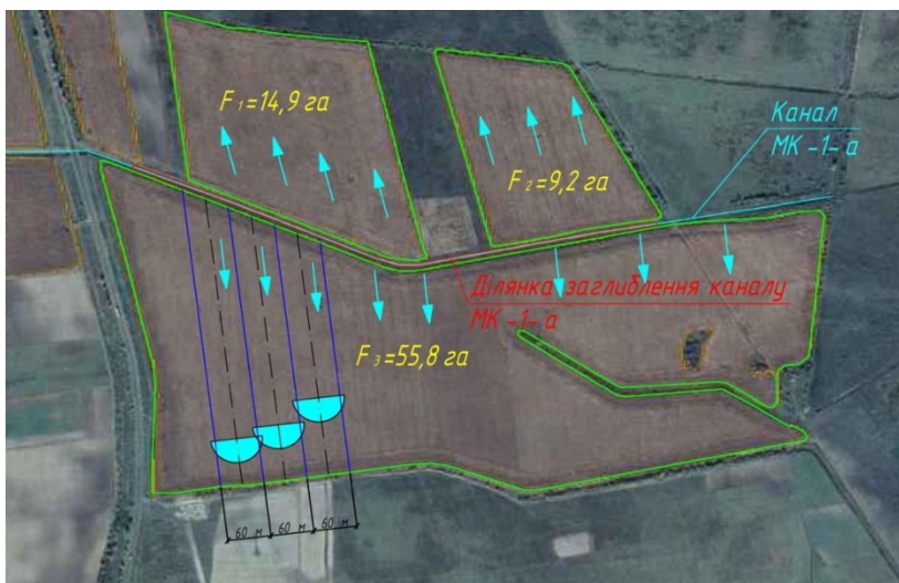
Рис. 6.11. Схема зрошувального контуру на ОС «Ольшанка»
