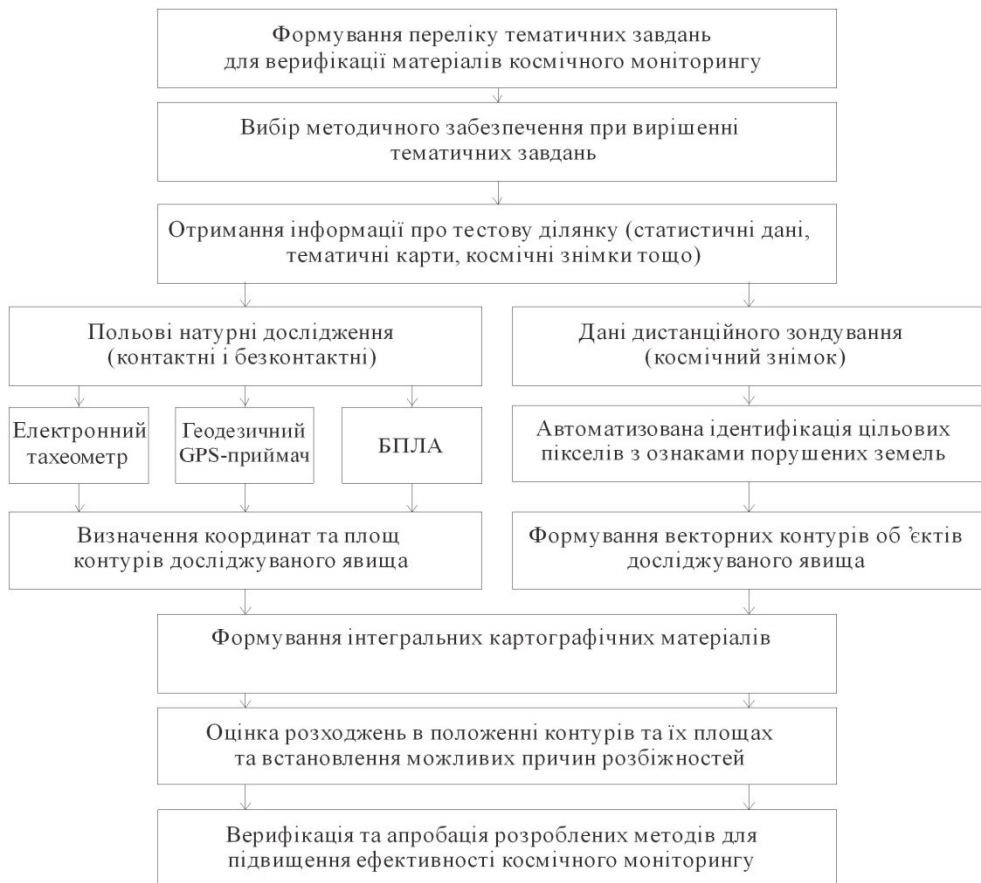
Рис. 21.23. Технологічна схема проведення досліджень по наземній польовій верифікації матеріалів космічних багатоспектральних знімків
