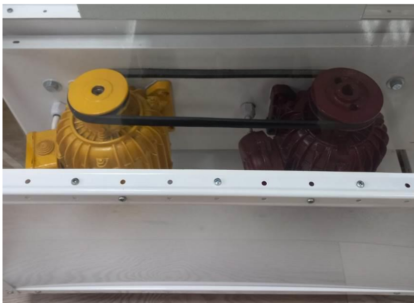
Рисунок 2.5 – Механічне з'єднання асинхронного двигуна та генератора
