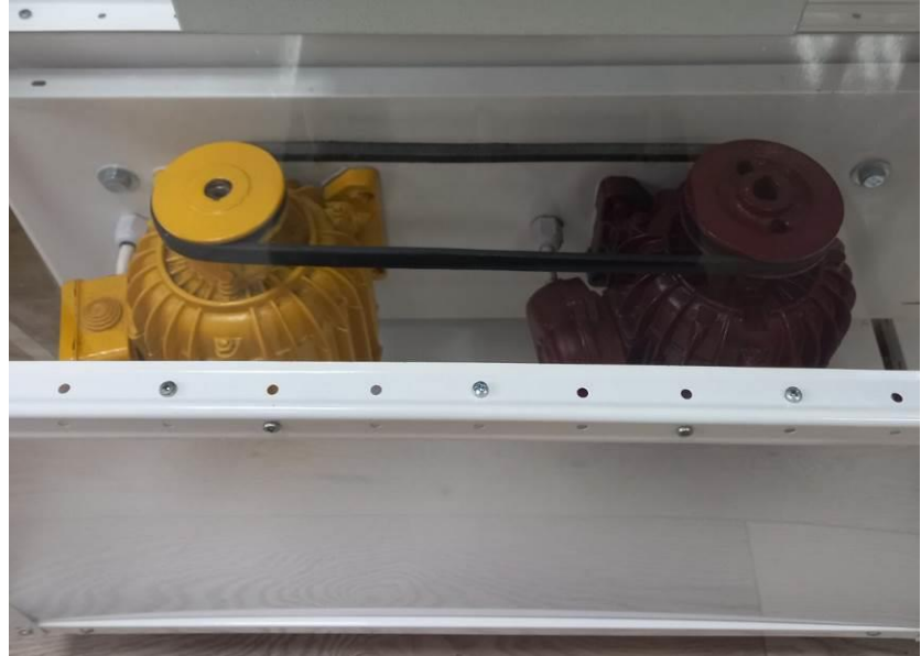
Рисунок 3.7 – Механічне з'єднання асинхронного двигуна та генератора
