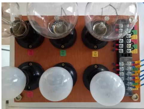
Рисунок 1.2 – Панель ламп розжарювання для створення активного навантаження
