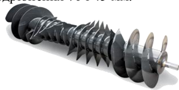
Рис. 4. Ротор системи OPTICUT
