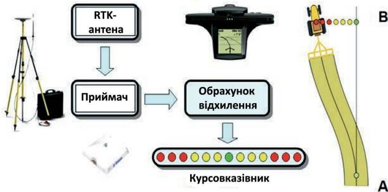
Рис. 1. Принцип функціонування курсовказівника
