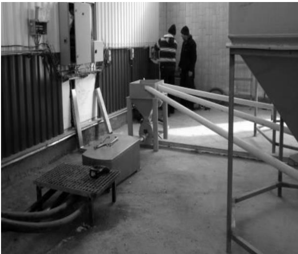
Рис. 3. Повітродувка з системою пневмоліній і центральним бункером для забезпечення автоматизованої годівлі риб у фермерському господарстві.
