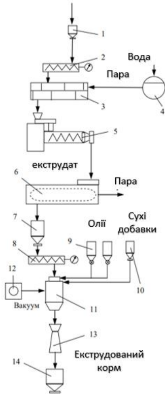
Рис. 6. Технологічна лінія екструдуювання розсипного комбікорму: 1, 7, 10 – оперативний бункер; 2, 8 – шнековий дозатор; 3 – кондиціонер; 4 – парогенератор; 5 – екструдер; 6 – сушарка; 9 – ємності для рідкої сировини; 11 – встановлення вакуумного наплення; 12 - вакуум-насос; 13 – охолоджувач; 14 – бункер для готового комбікорму
