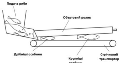
Рис. 9. Процес сортування риби на сортувальній машині з похило розташованим обертовим роликом.
