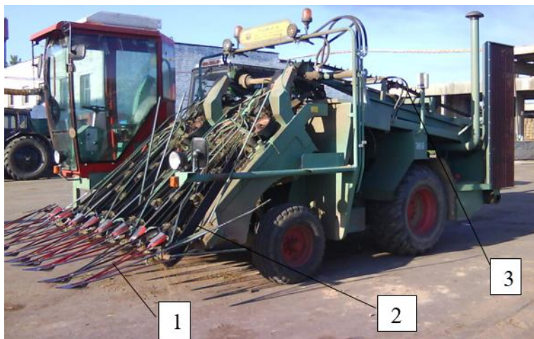
Рис. 4.2 – Самохідна бралка ТЛС-2,4: 1 – подільники, 2-бральні паси, 3- транспортер стебел льону.
