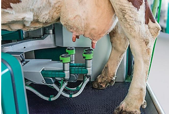
Рисунок. Доїльний робот «Монобокс» компанії GEA
