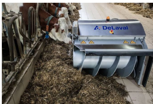
Рис. 3. Робот для просування корму ближче до корів або робот-пушер
