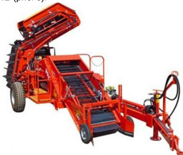
Рис. 5. Машина для збирання цибулі Імас RC 80/90-NE
