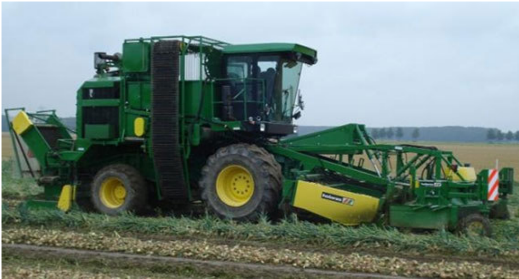
Рис. 7. Самохідний комбайн для збирання цибулі фірми Holars (Нідерланди)
