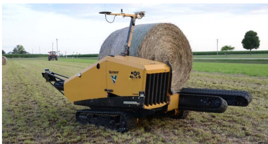
Рис. 2. Vermeer Balehawk: автономна обробка сіна
