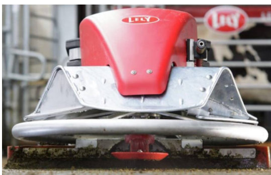
Рис. 4. Робот для прибирання гною
