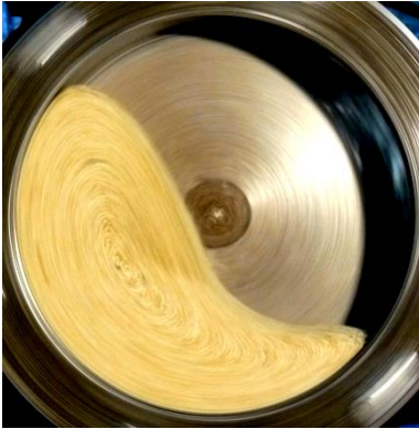
Рис. 5.2. Картина руху незв'язного зернистого заповнення обертової камери при D_f=0,01 , R=0,106 м, \kappa=0,4 та \psi_\omega=0,7
