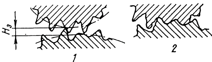
Рис. 3.18. Схема контакту частинок з шорсткими поверхнями із зазором H_3 між контактуючими поверхнями:
