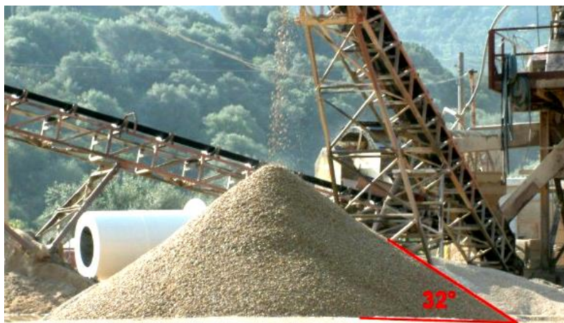
Рис. 3.28. Схема утворення кута природного укосу зернистого матеріалу
