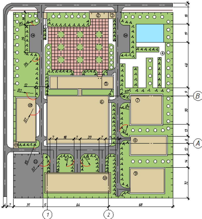
Рисунок 7 – Приклад виконання генерального плану промислового підприємства
