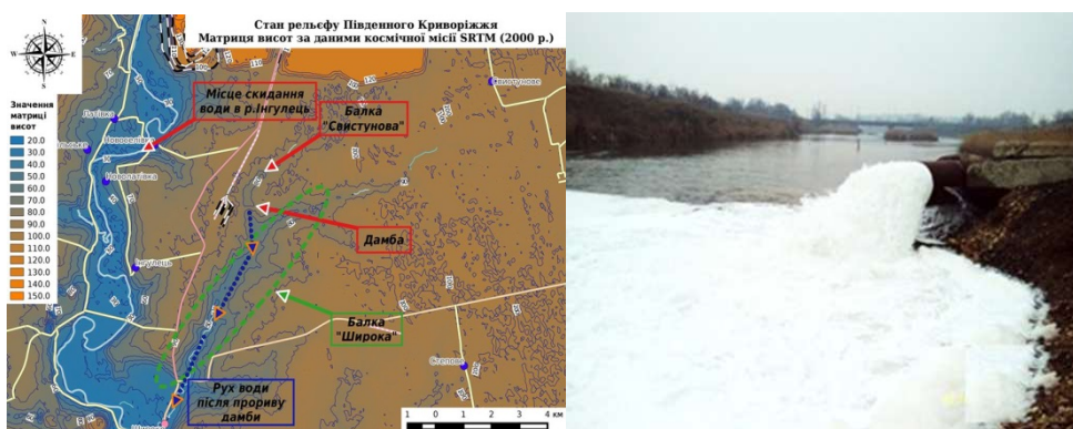
Рис. 2. Схема балки Свистунова та скид шахтних вод у р. Інгулець
