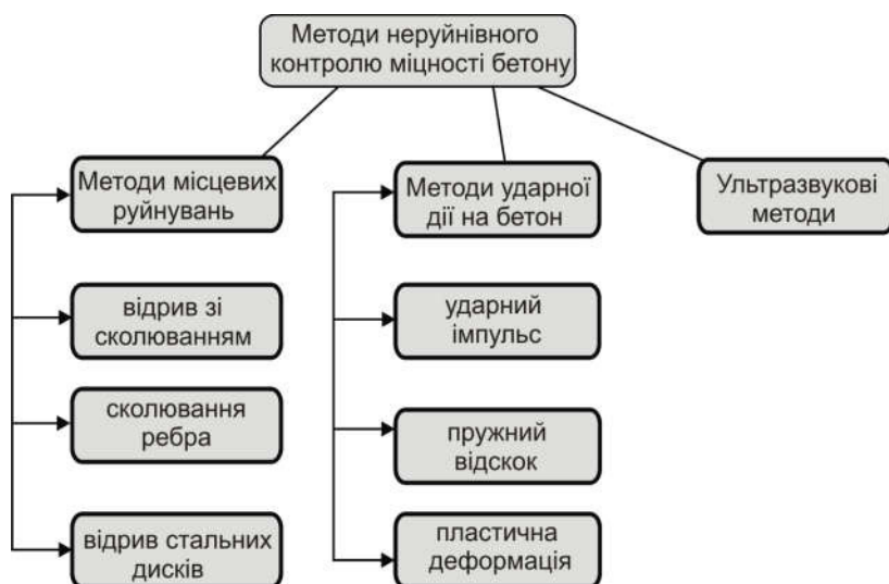
Рис. 5.8. Класифікація методів неруйнівного контролю міцності бетону
