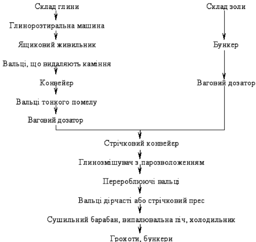
Рис. 1.8. Технологічна схема виготовлення глинозольного гравію
