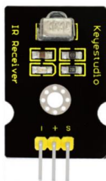
Рис. 7. Модуль інфрачервоного приймача
