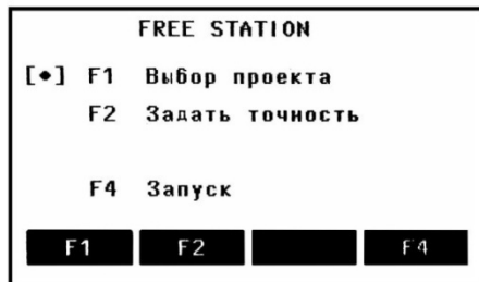
Рис. 8.25. Запуск вимірювань в режимі «Вільна станція»
