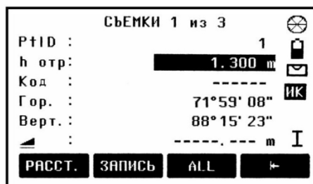
Рис. 8.15. Контроль розмічувальних елементів на дисплеї тахеометра
