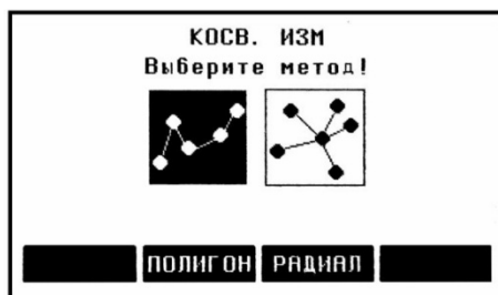
Рис. 8.22. Вибір режиму вимірювання недоступної відстані
