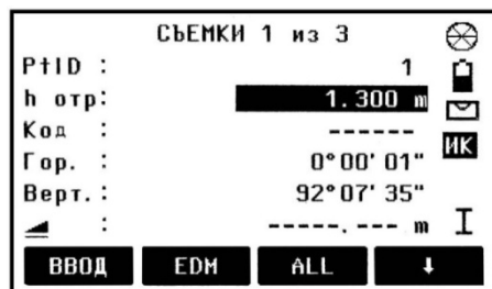
Рис. 6.4. Вигляд дисплею в режимі тахеометричного знімання
