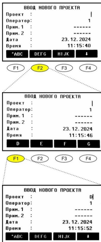
Рис. 6.1. Організація вводу цифр та літер в тахеометрі TCR 405 Ultra
