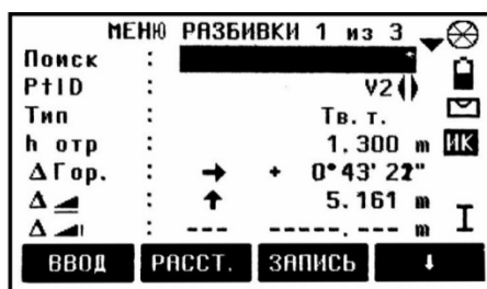
Рис. 8.12. Винесення точки в натуру в режимі «Розбивка»
