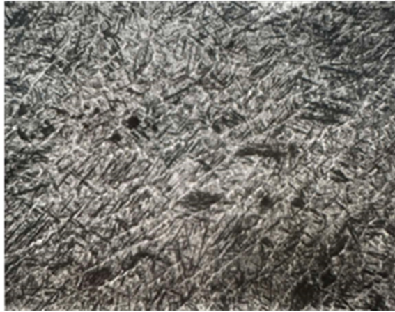
Рис. 4. Структура металу, наплавленого за варіантом 4, в середній частині шва, \times 340
