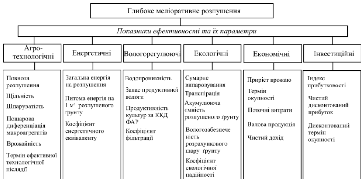
Рис. 24. Комплекс показників оцінювання загальної ефективності технологій і технічних засобів глибокого розпушення
