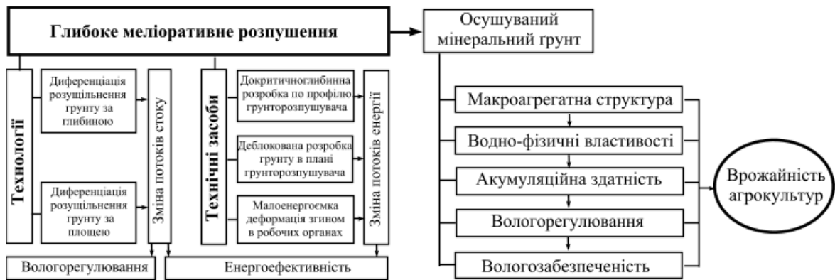
Рис. 3. Причинно-наслідкові зв'язки глибокого меліоративного розпушення, удосконаленого за принципами енергоефективності та вологорегулювання як складової меліоративної системи
