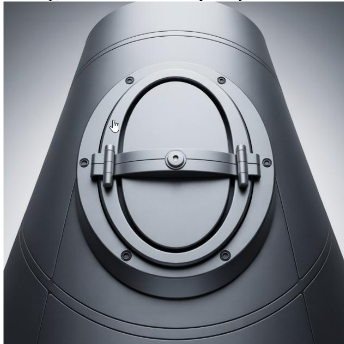
Рисунок. Ескізне зображення: еліптичний люк у циліндричній оболонці
