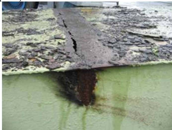
Рис. 1. Втомлене руйнування стріли у місцях стикування листів металоконструкції
