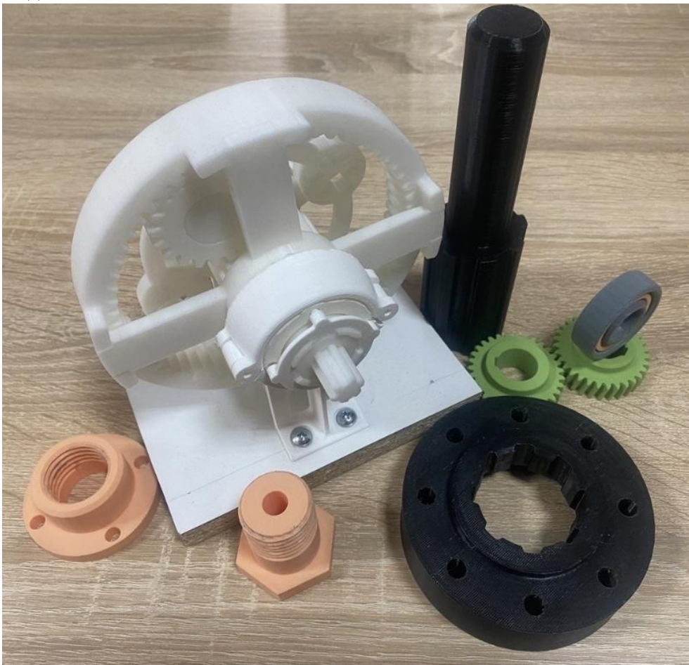
Рис. 3. Фізичні моделі деталей та вузлів виготовлені за допомогою адитивних технологій
