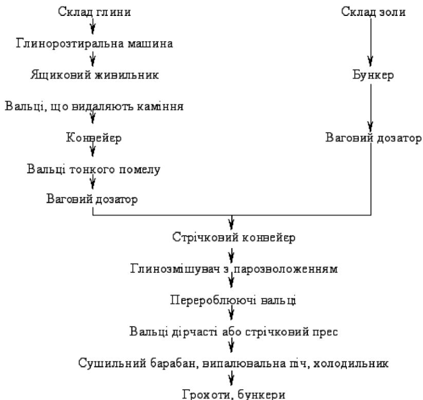
Рис. 1.8. Технологічна схема виготовлення глинозольного гравію
