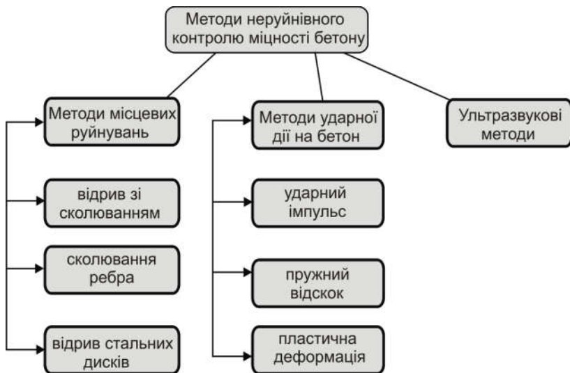
Рис. 5.8. Класифікація методів неруйнівного контролю міцності бетону
