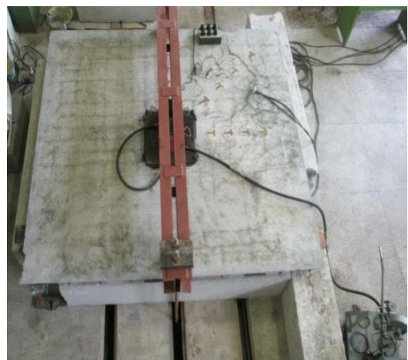
Рис. 1. Схема випробування надколонних плит серії ПН-2:
