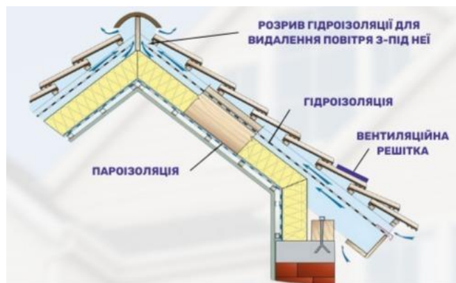
Рис. 2. Влаштування вентиляції
