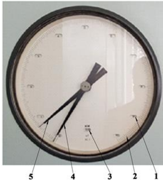
Рис. 9. Циферблатний індикатор діючого і руйнівного на зразок зусилля
