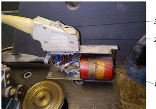
Рис. А-7. Схема з'єднання гніздової колодки кабеля електронного динамометра з гніздовою колодкою кабеля навантажувального пристрою
