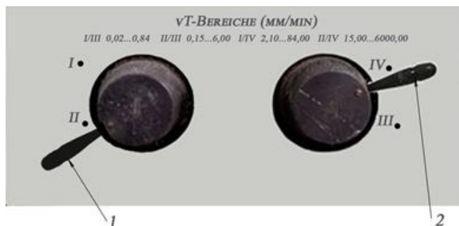
Рис. 6. Панель перемикання швидкості руху навантажувальної балки
