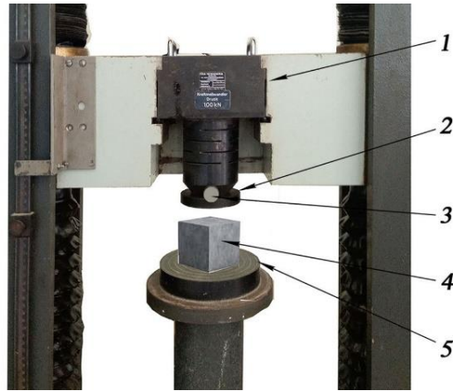
Рис. 3. Робоча частина навантажувального пристрою 1 – електронний динамометр Druck KMW 100 кН; 2 – верхня навантажувальна тарілка; 3 – гвинт кріплення верхньої навантажувальної тарілки; 4 – піногіпсовий зразок-куб; 5 – нижня опорна тарілка
