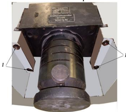
Рис. А-5. Схема кріплення електронного динамометра в ніші навантажувальної балки 1 – стопорні гвинти
