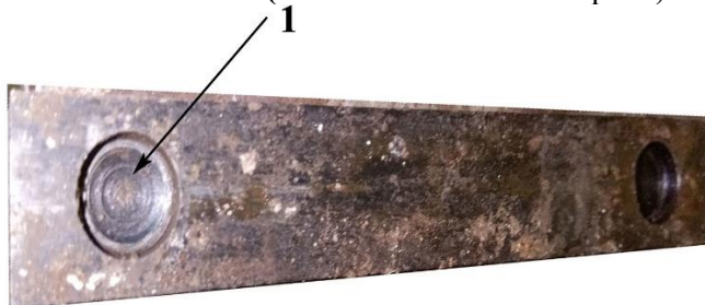
Рис. А-4. Пластина ковзання 1 – виїмка під стопорний гвинт
