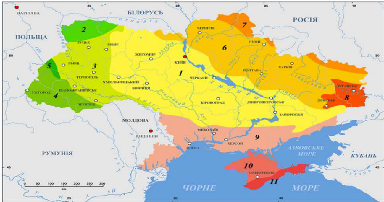
Рис. 1.4. Основні тектонічні структури України: 1 – Український кристалічний щит; 2 – Ковельський виступ; 3 – Волинсько-Подільська плита; 4 – Карпатська складчаста область; 5 – Західноєвропейська платформа; 6 – Дніпровсько-Донецька западина; 7 – Воронежський масив; 8 – Донецька складчаста область; 9 – Причорноморська западина; 10 – Скіфська плита; 11 – Кримська складчаста область
