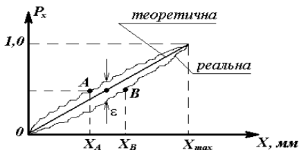
Рис. 4.3. Тягова характеристика пневматичного мембранного механізму
