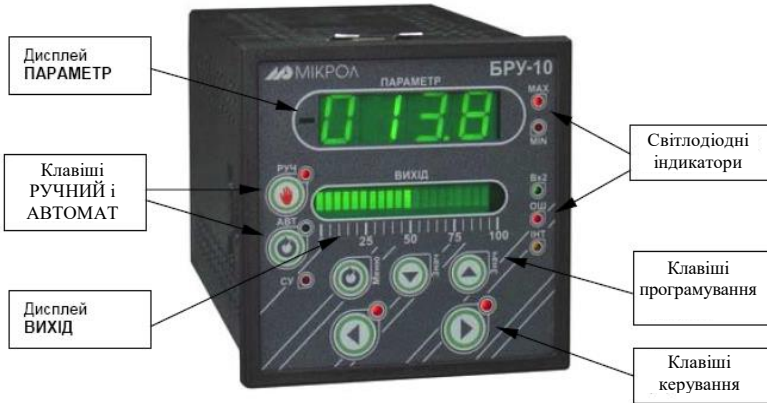
Рис. 1.2. Зовнішній вигляд передньої панелі блоку ручного керування БРУ-10
