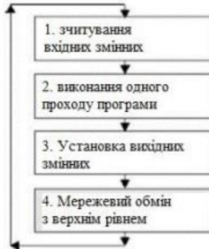
Рис. 3.2. Блок-схема роботи контролера МІК-51
