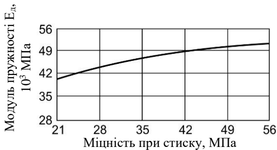
Рис. 2.11. Залежність між динамічним модулем пружності і міцністю бетону при стиску
