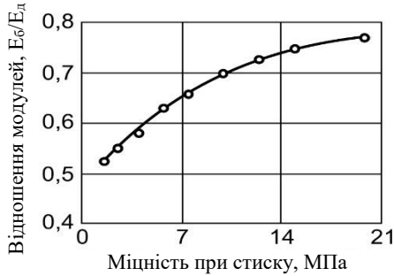
Рис. 2.12. Відношення статичного модуля пружності до динамічного для бетонів різної міцності
