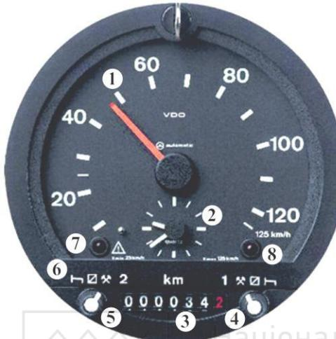
Рис. 2.2. Зовнішній вигляд циферблата тахографа:
