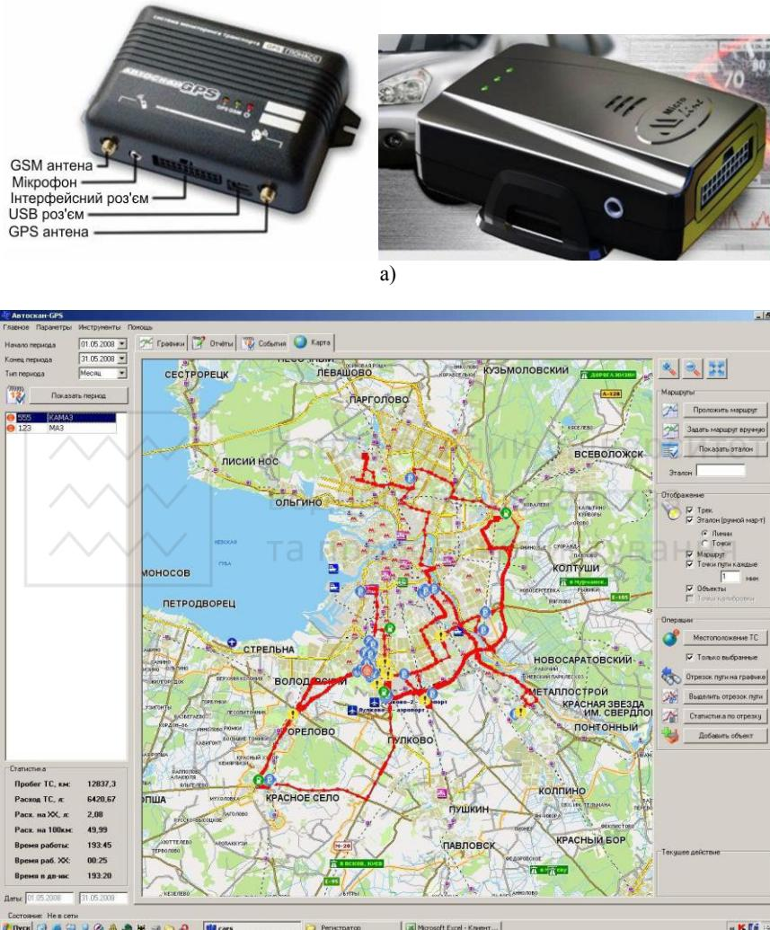
Рис. 12.5. Елементи системи АвтоСКАН GPS: а) будований модуль; б) інтерфейс користувача
