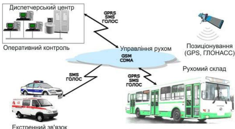
Рис. 11.1. Структура типової автоматизованої системи диспетчерського управління пасажирським транспортом
