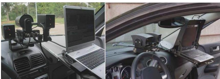
Рис. 13.3. Зовнішній вигляд апаратно-програмного комплексу «ПОТОК-Д», встановленого у патрульному автомобілі
