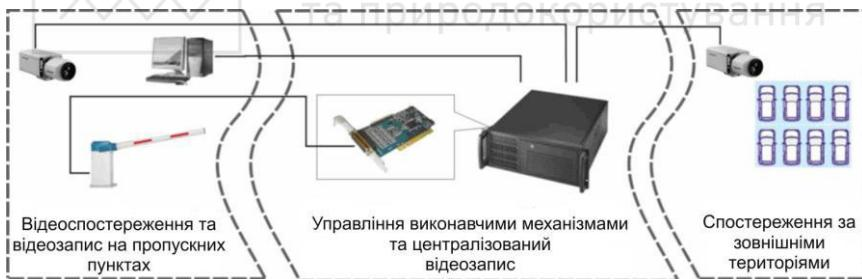
Рис. 13.1. Загальна структура систем автоматичного розпізнавання номерних знаків
