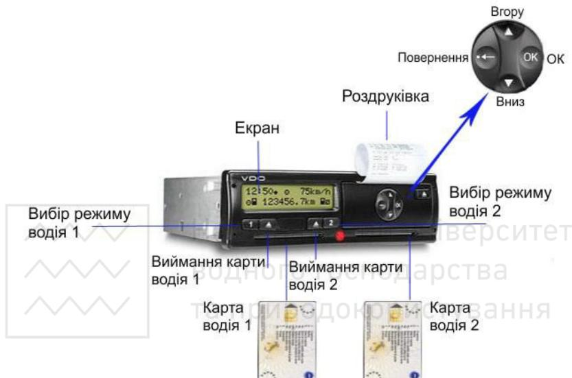
Рис. 2.4. Елементи настроювання цифрового тахографа
