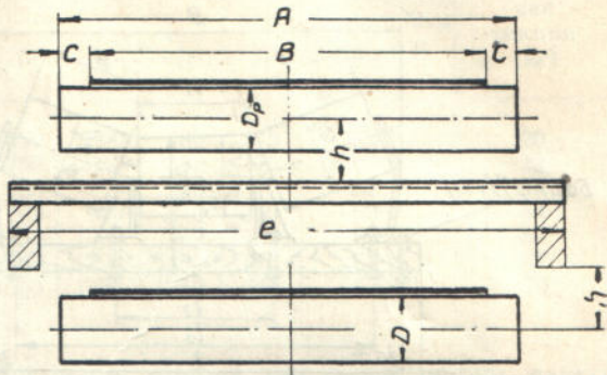
Фиг. 155. Однороликовая опора по нормам DIN.
