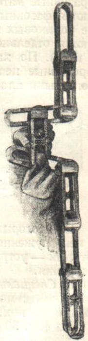
Фиг. 35. Сборка и разборка цепи Кейстон.
