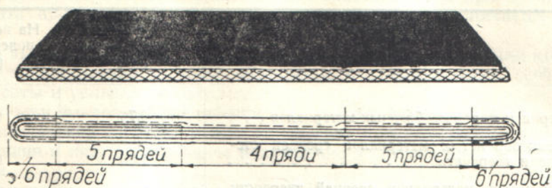
Фиг. 142. Сечение резиновой ленты ступенчатого типа.
