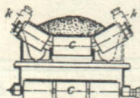
Фиг. 141. Опорные ролики для лотковой ленты.
