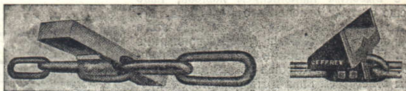
Фиг. 642. Таскалки на длиннозвенных сварных цепях (Jeffrey).
