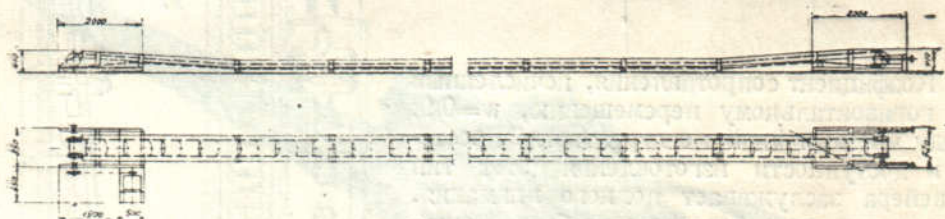
Фиг. 732. Конвейер со сварными цепями (Hasenclever).
