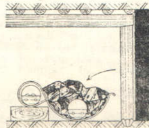
Фиг. 737. Канатный тормозящий конвейер (Eisenhütte Westfalia).
