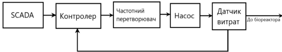
Рисунок. 1. Структурна схема регулювання витрат стічних вод
