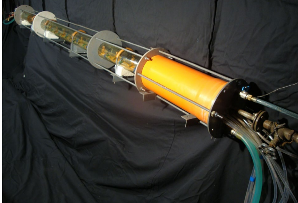
Рис. 3. Загальний вигляд експериментального трубопроводу-збирача, поміщеного в прозорий напірний футляр: а - вид на вхідну частину з витратомірами; б – те саме, вихідну з імпульсними лініями до п'єзометрів
