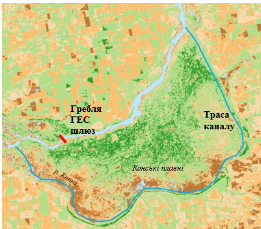
Рис. 2. Ілюстративний приклад облаштування обхідного водопропускного і рибохідного каналу (модель SAVI на основі Landsat 8 від 14.07.2024)
