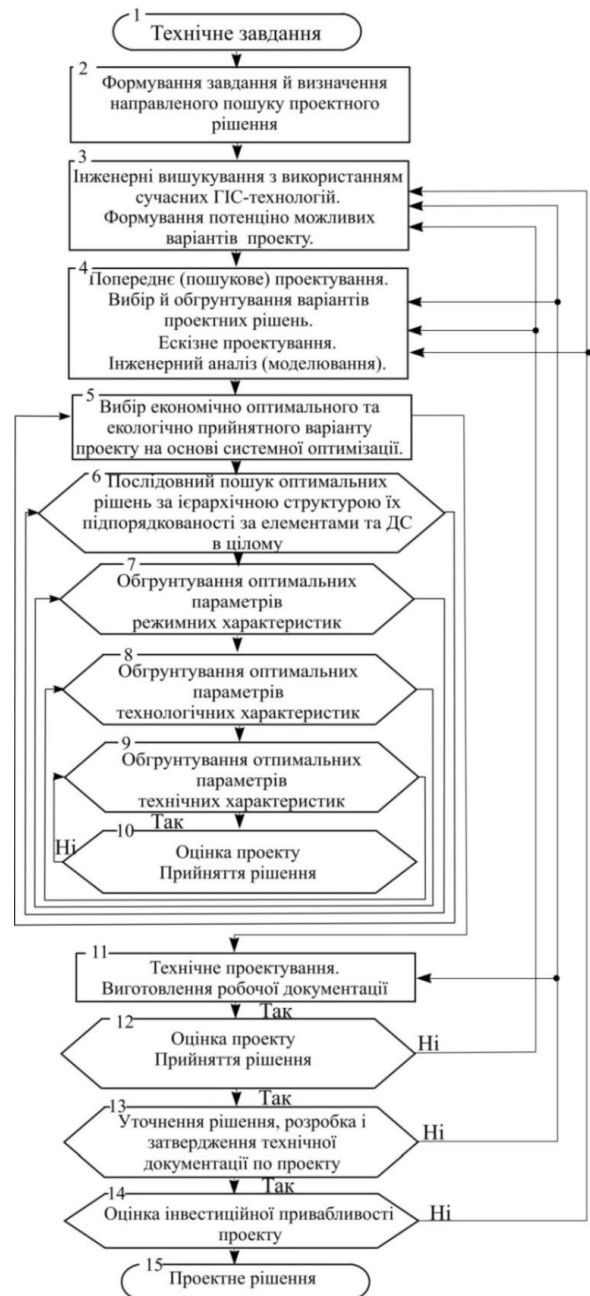
Рис.1. Схема процесу проектування за базовими проектними процедурами на багатоваріантній основі за системною оптимізацією
