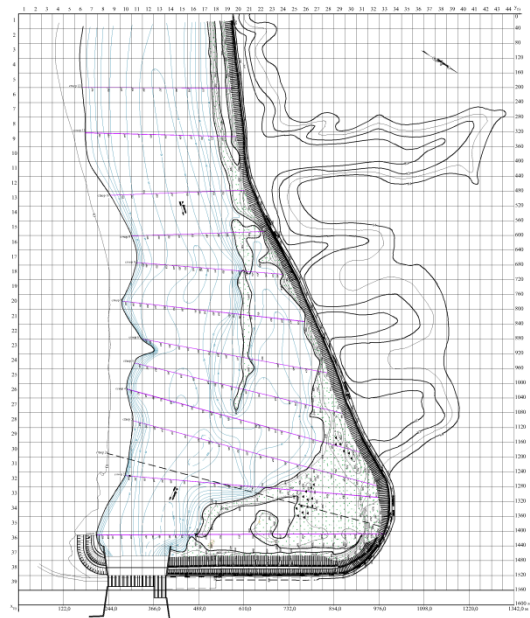
Рисунок 1. Результати промірювання рельєфу дна акваторії верхнього б'єфу Нижньодністровської ГЕС
