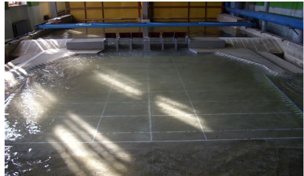
Рисунок 6. Модель бокового водозливу № 2 на р. Тиса біля с. Вари в Закарпатській області (моделювання проходження розрахункового паводка та заповнення ємкості)
