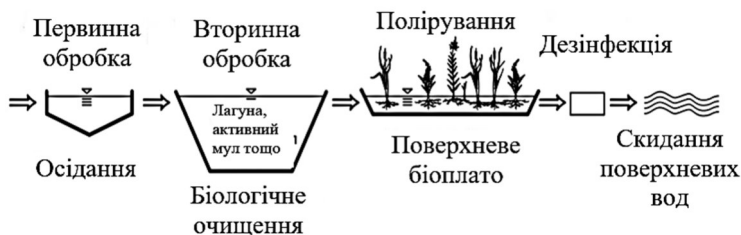
Рис. 10.2. Типове застосування водно-болотних угідь вільної поверхні для очищення міських стічних вод
