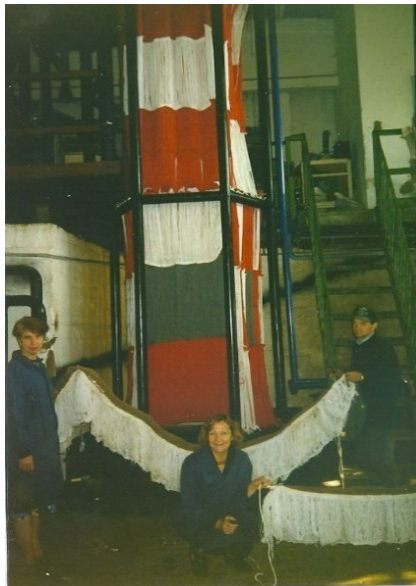
Рис. 9.18. «Вежа» (біофільтр) для очищення води від нафтопродуктів та іонів заліза (Чернігівський завод «Автомодель»)
