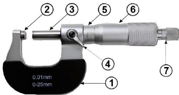
Рис. 5. Мікрометр: 1 – скоба, 2 – п'ятка, 3 – мікрометричний гвинт, 4 – стопор, 5 – стебло, 6 – барабан, 7 – корпус тріскачки
