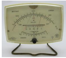
Рис. 2. Прилади для вимірювання вологості повітря: 1 - психрометр ВІТ-1 0-25; 2 – барометр-гігрометр БМ 2; 3 - гігрометр ТФА
