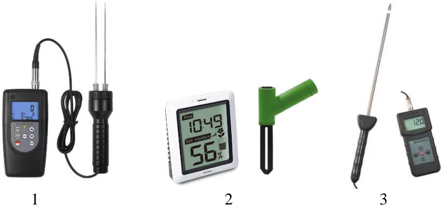
Рис. 9. Вологоміри ґрунту: 1 – Walcom MC-7828SOIL; 2 – Misol WH-0291S-1; 3 – Walcom PMS-710
