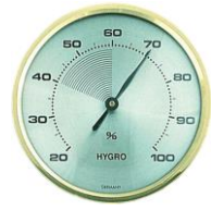
Рис. 2. Прилади для вимірювання вологості повітря: 1 - психрометр ВІТ-1 0-25; 2 – барометр-гігрометр БМ 2; 3 - гігрометр ТФА
