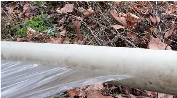
Рис. 17. Розрив труби після зимових морозів
