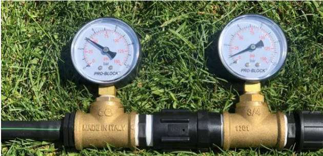
Рис. 16. Редуктор тиску 1 бар для крапельного поливу (вхідний тиск до 5,5 бар, вихідний від 0,3 до 0,7 м 3 /год)
