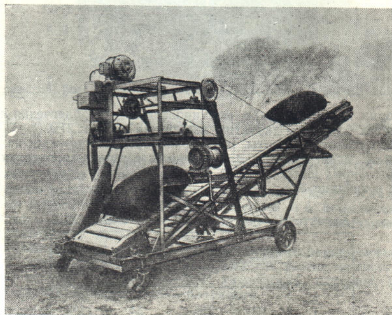
Фиг. 160. Штабеллер для тяжелых единичных грузов (W. & C. Pantin).
