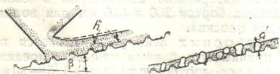
Фиг. 102. Слой материала на волнистой ленте.
