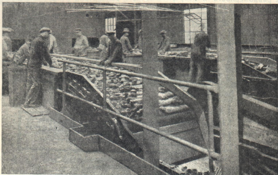
Фиг. 131. Породоотборная лента с ящиками для породы (Link-Belt).
