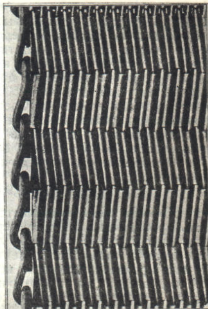
Фиг. 177. Лента закрытой конструкции с волнистой полосой.
