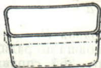
Фиг. 367. Литые чугунные ковши с изогнутыми спинками по выпуклости барабана (Chain Belt).
