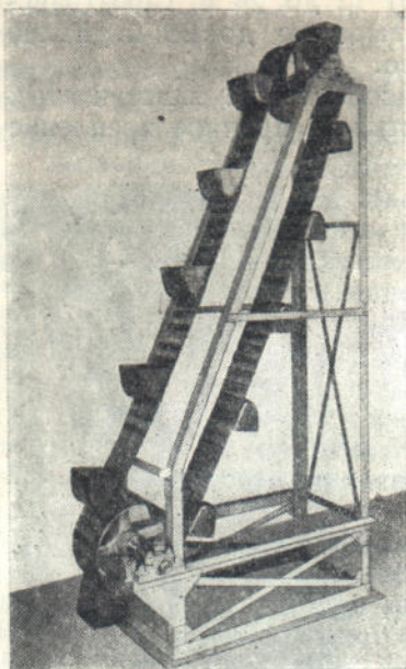
Фиг. 287. Элеватор на ленте из стальной проволоки (Luis Hermann).
