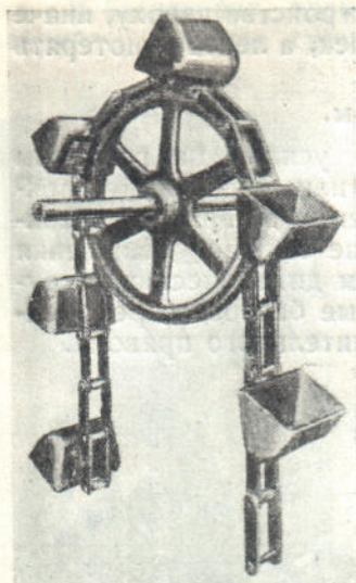
Фиг. 396. Элеватор с гладким приводным шкивом (Stephens-Adamson).
