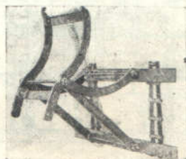
Фиг. 466. Форма захватов на элеваторах для штучных грузов (Chain Belt).
